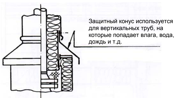
Рис. 17б. Защитный конус для вертикальных участков трубопроводов
