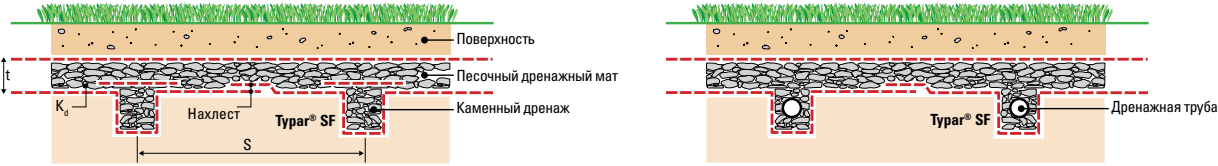
Рисунок 29. Участок с применением двух дренажных слоев Tyrag® SF
